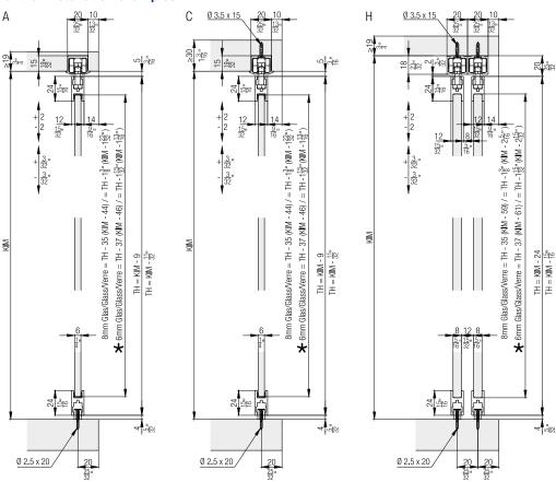
★ Zentrierhilfe für 6mm Glas Centering help for 6mm glass Aide de centrage pour verre 6mm
